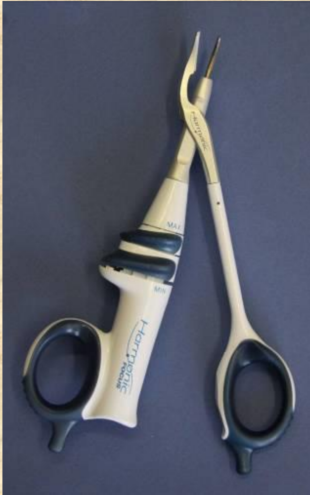
Harmonický skalpel – piezoelektrický jev
